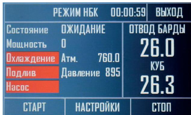
Информация на главном экране в режиме НБК, ничем не отличается от других режимов, за исключением использования датчика давления, на данный момент он несет информационное значение (в следующих прошивках он будет использоваться именно в режимах работы.)
